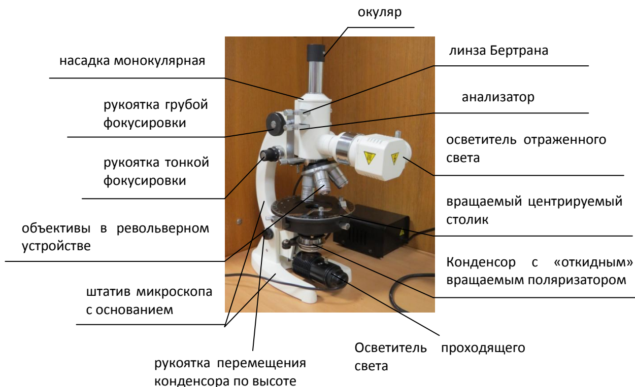
Рисунок 4 – Общий вид и состав поляризационного микроскопа
